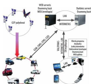
2 pav. Palydovinės kontrolės sistemos struktūra
