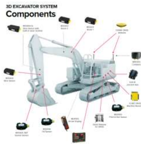
1.attēls. Būvmašīnas digitālais automatizācijas aprīkojums – sensori, mikro kontrolieri, signālu raidītāji un uztvērēji.
