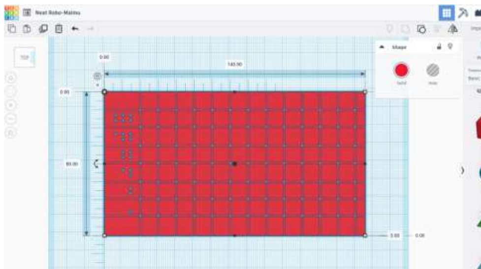
34. attēls. Ciklogramma ar noformētām tvērienu, laika robežlīnijām, tvērienu marķieriem un darba procesu līniju turētāju caurumiem.
