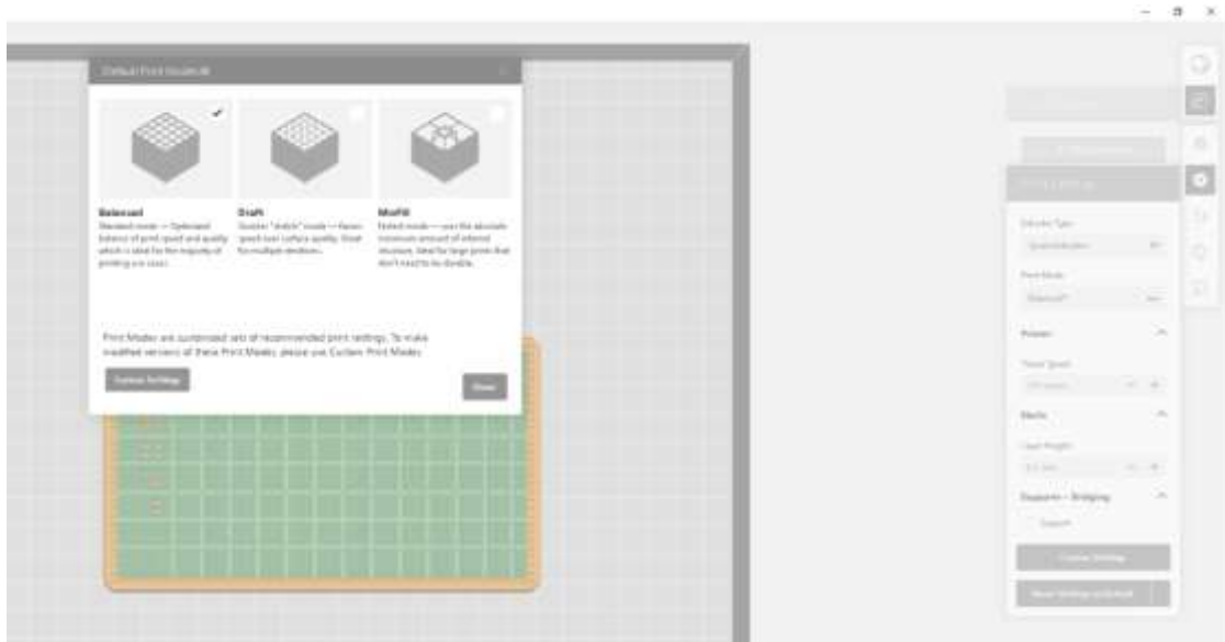
22. attēls. Izdrukāšanas opciju uzstādīšana. Izvēlne Print Settings – Print Mode. Apakšizvēlnes Balanced, Draft un MinFill.
